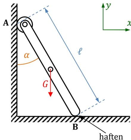
Irrtümlich wird nun die Leiter falsch herum aufgestellt, das heißt die reibungsfreie Rolle berührt den Boden im Punkt B und die Gummibeschichtung die Wand im Punkt A.
