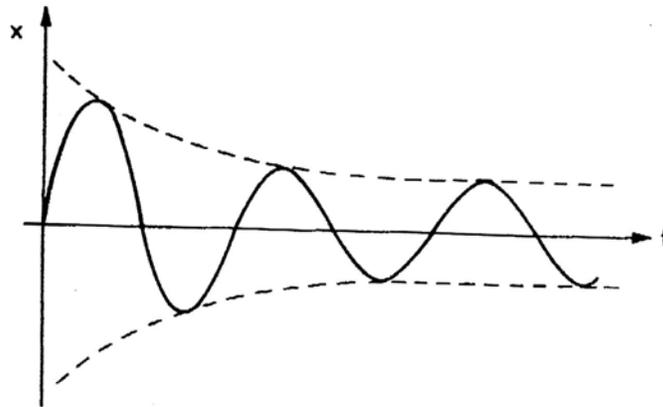
Die graphische Darstellung der Bewegung (4) des schwachgedämpften Oszillators mit periodischer äußerer Kraft.
