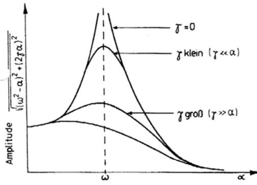
Die Amplitude der erzwungenen gedämpften Schwingung als Funktion der Erregerfrequenz  $\alpha$ .
