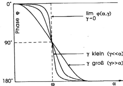
Die Phasenverschiebung des Oszillators gegenüber der erregenden Schwingung in Abhängigkeit von der Erregerfrequenz  $\alpha$ , also Darstellung von  $\varphi = -\arctan \frac{2\gamma\alpha}{\omega^2 - \alpha^2}$ .
