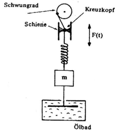
Veranschaulichung eines gedämpften Systems mit periodischer äußerer Kraft.
