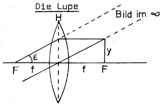
Die Lupe ist eine Sammellinse kurzer Brennweite. Der Gegenstand befindet sich in der Brennebene. Das virtuelle Bild ist dann im  $\infty$ .
