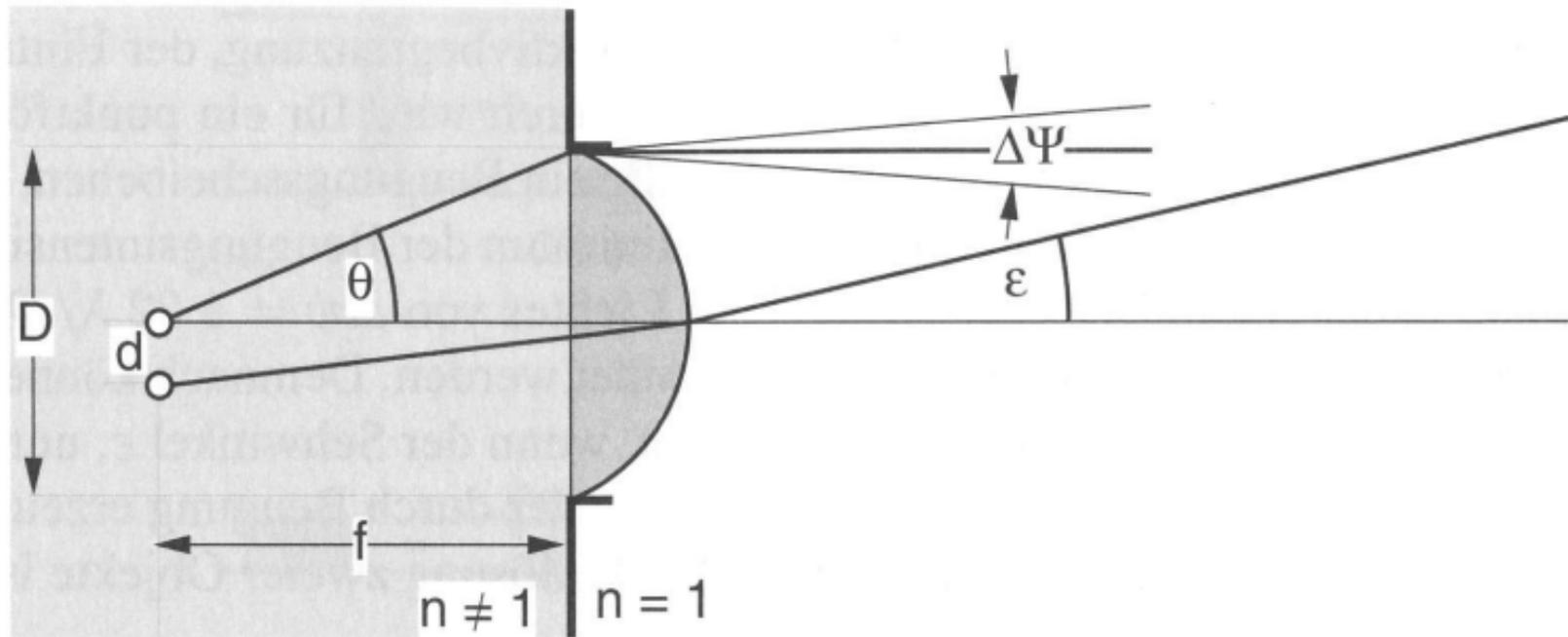
**Bild 4.53:** Das Auflösungsvermögen eines Mikroskops nach Helmholtz. Zwei nahe benachbarte selbstleuchtende Punkte können dann noch getrennt beobachtet werden, wenn der Sehwinkel  $\varepsilon$ , unter dem sie zu beobachten sind, größer ist als die durch Beugung an der Objektivöffnung  $D$  verursachte Winkelunschärfe  $\Delta\psi$ .
