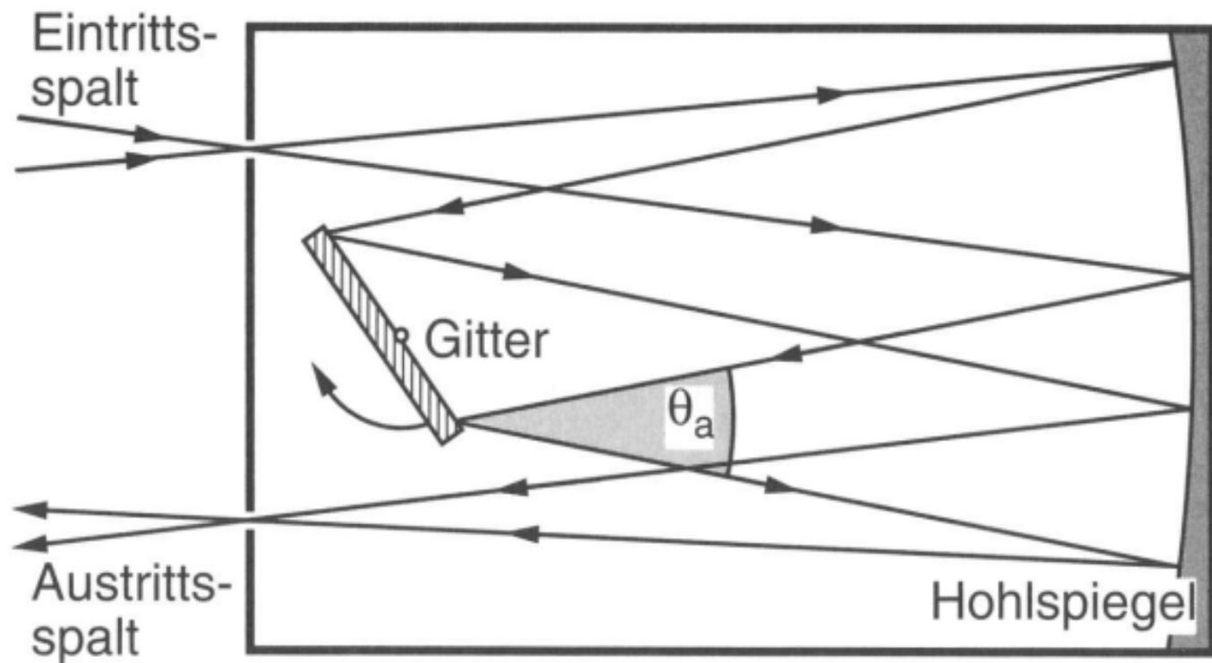
**Bild 4.26:** Gitterspektrometer. Typischer Aufbau eines Gitterspektrometers mit Reflexionsgitter und abbildendem Hohlspiegel.
