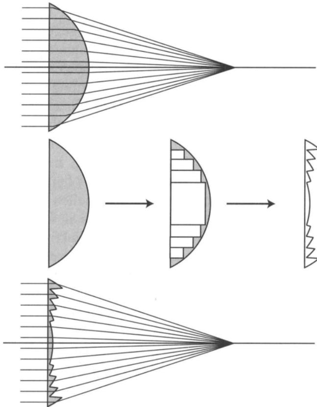
**Bild 3.42:** Fresnellinse. Da die Lichtablenkung an einer Linse nur an den geneigten Oberflächen erfolgt, kann man die zentralen, planparallelen Anteile von Linsen entfernen und so sehr dünne Fresnellinsen herstellen.
