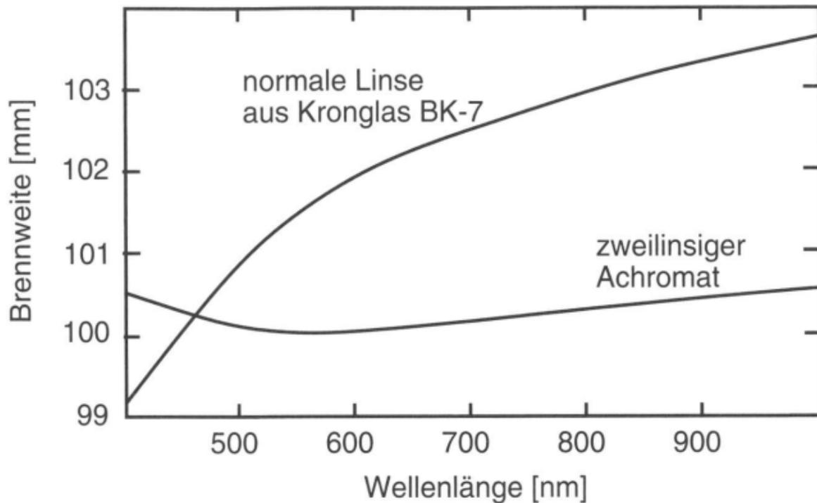
**Bild 3.36:** Chromatische Aberration bei einer einfachen Linse und bei einem Achromaten. Während bei einer einfachen Kronglaslinse eine starke Wellenlängenabhängigkeit im sichtbaren Spektralbereich vorliegt, tritt bei einem zweilinsigen Achromat ein wesentlich kleinerer chromatischer Fehler auf.
