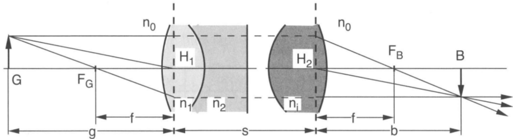
**Bild 3.27:** Die Abbildung an einem komplizierten zentrierten System lässt sich durch Einführen zweier Hauptebenen  $H_1$  und  $H_2$  behandeln. Dabei kann bei der Konstruktion des Bildes wie bei der Abbildung an einer dünnen Linse vorgegangen werden. Es muss jedoch zwischen den Hauptebenen eine achsenparallele Führung der Strahlen benützt werden.
