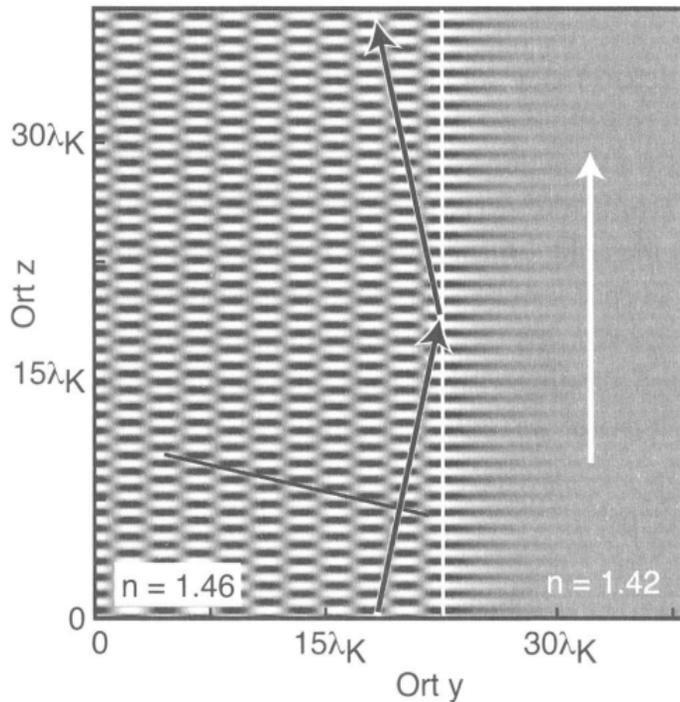
**Bild 2.19:** Feldstärken bei Reflexion einer ebenen Welle (Polarisation parallel zur Grenzfläche) an einer dielektrischen Grenzfläche (weiße Linie). Durch die Überlagerung von einfallendem und reflektiertem Licht (Wellenvektoren als Pfeile symbolisiert) entsteht vor der Grenzfläche ein Interferenzmuster. Hinter der Grenzfläche beobachtet man eine Feldstärke, die exponentiell mit wachsendem Abstand von der Grenzfläche abnimmt.
