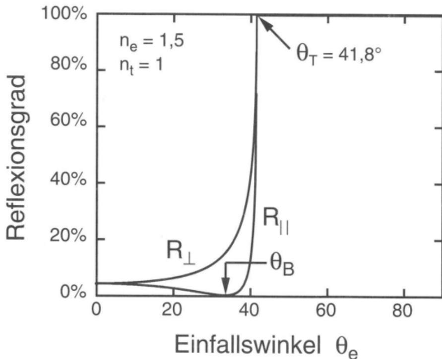
**Bild 2.17:** Abhängigkeit des Reflexionsgrades vom Einfallswinkel  $\theta_e$  für Einstrahlung aus dem optisch dichteren Medium,  $n_e > n_t$ . Wieder beobachtet man einen Brewsterwinkel  $\theta_B$ , bei dem die Reflexion  $R_{\parallel}$  verschwindet. Für Einfallswinkel, die größer als der Totalreflexionswinkel  $\theta_T$  sind, wird  $R_{\parallel} = R_{\perp} = 100\%$ .
