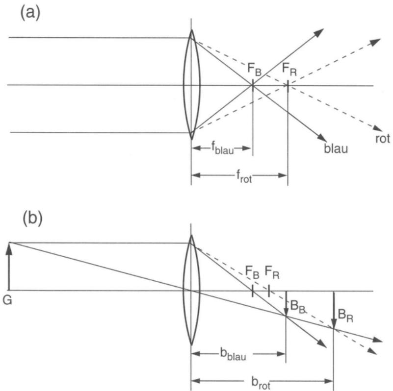
**Bild 3.35:** Chromatische Aberration: Durch die Wellenlängenabhängigkeit der Brechzahl wird die Brennweite einer einfachen Linse für blaues Licht kleiner sein als für rotes Licht (a). Dies hat zur Folge, dass bei einer Abbildung das rote und das blaue Bild in verschiedenen Bildweiten mit unterschiedlichen Bildgrößen auftreten (b).
