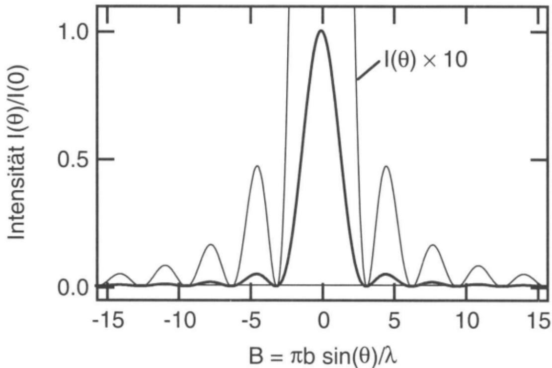
**Bild 4.14:** Intensitätsverlauf bei Beugung an einem langen Spalt. Bei der dünn gezeichneten Kurve wurde die Intensität mit 10 multipliziert, damit der Verlauf der Beugungsintensität auch für größere Ablenkwinkel  $\theta$  verfolgt werden kann.
