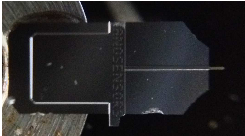
Abb. 7.7.: Makrofotographie eines mikrotechnologisch hergestellten AFM-Cantilevers (Biegebalken)
