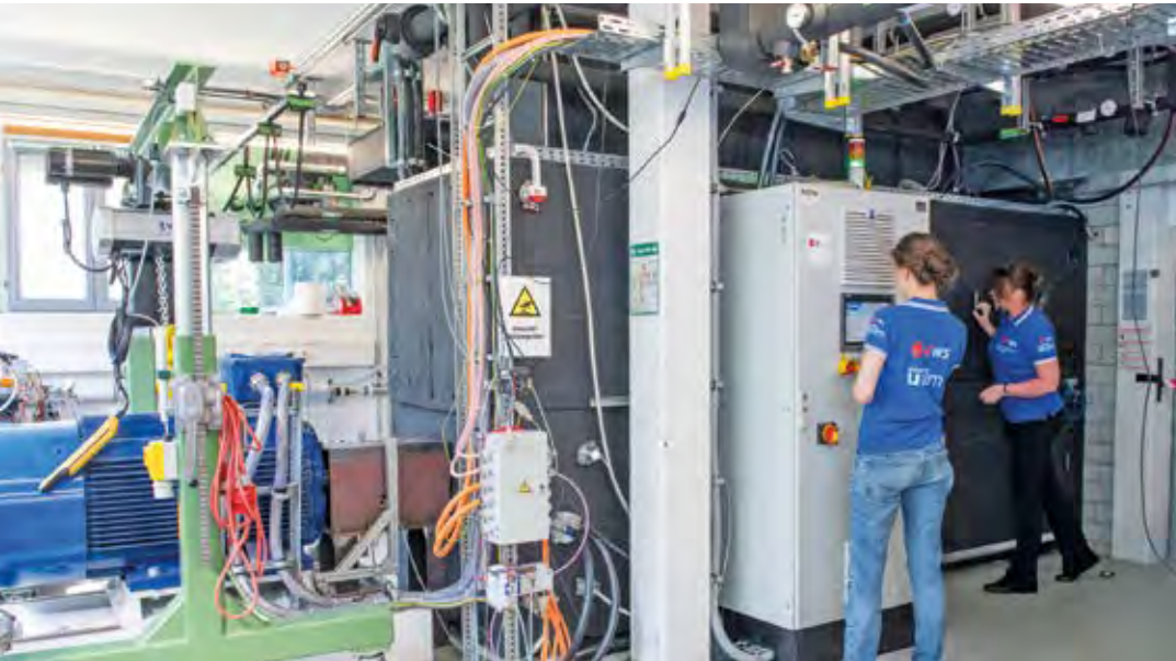
Im vollklimatisierten Unterdruck-Prüfstand werden Brennstoffzellen-Antriebe getestet Foto: Elvira Eberhardt
