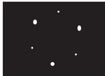
Abbildung 4.25.: Schematische Skizze eines LEED-Bildes von Ni (111) bei einer Primärenergie von 205 eV (gezeichnet nach [JSY82]).
